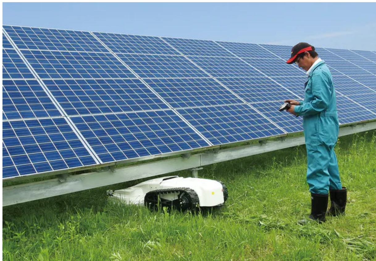
太陽光発電所の架台の下で草を刈るササキコーポレーションの電動リモコン作業機「スマモ」
